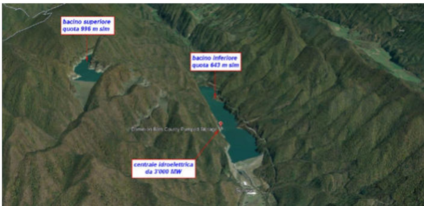
*Impianto di accumulo idroelettrico di Bath County - West Virginia (USA). Il più grande impianto del genere al mondo con una potenza di 3'000 MW, generati da un flusso di 850 metri cubi al secondo di acqua che scende lungo condotte forzate dal Bacino superiore, che ha una capacità di 14 milioni di metri cubi di acqua, al bacino inferiore, per un dislivello di circa 350 m*
